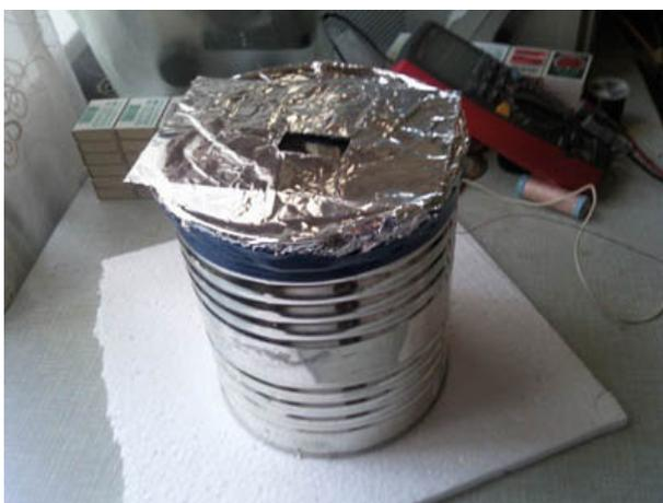
Оборачиваем это упаковочным материалом – плохо проводит тепло, зато проводит свет и ИК.
